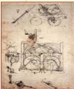
Plano original del 'automóvil' creado por Leonardo
